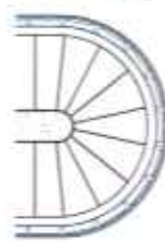
Fig. 09 pinta a pettine e a camera d'aria con insonorizzante "Dolpac"
